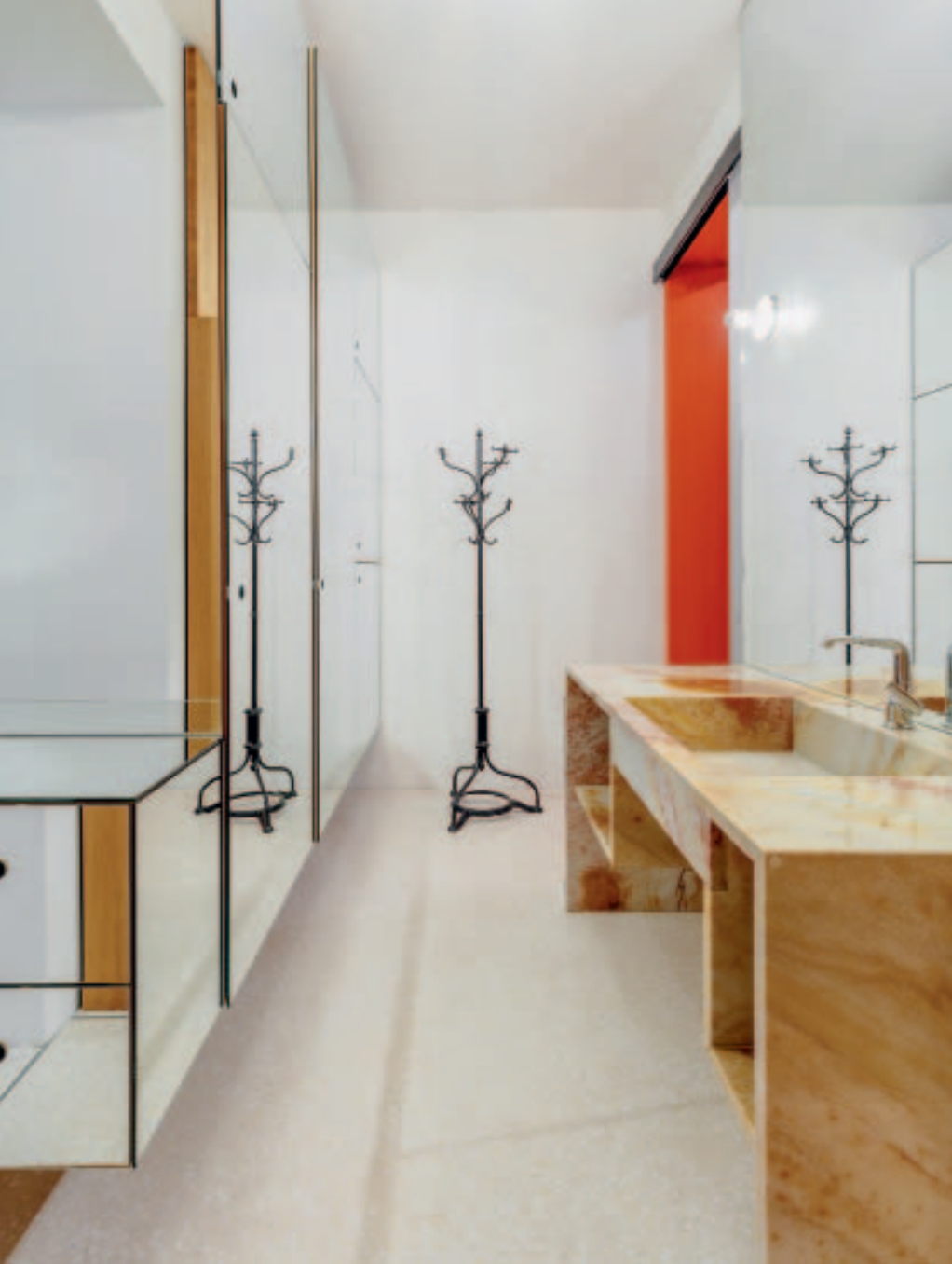
Massgeschneidert: Im Badezimmer bestehen Waschbecken und Duschbereich aus Natursteinplatten.
