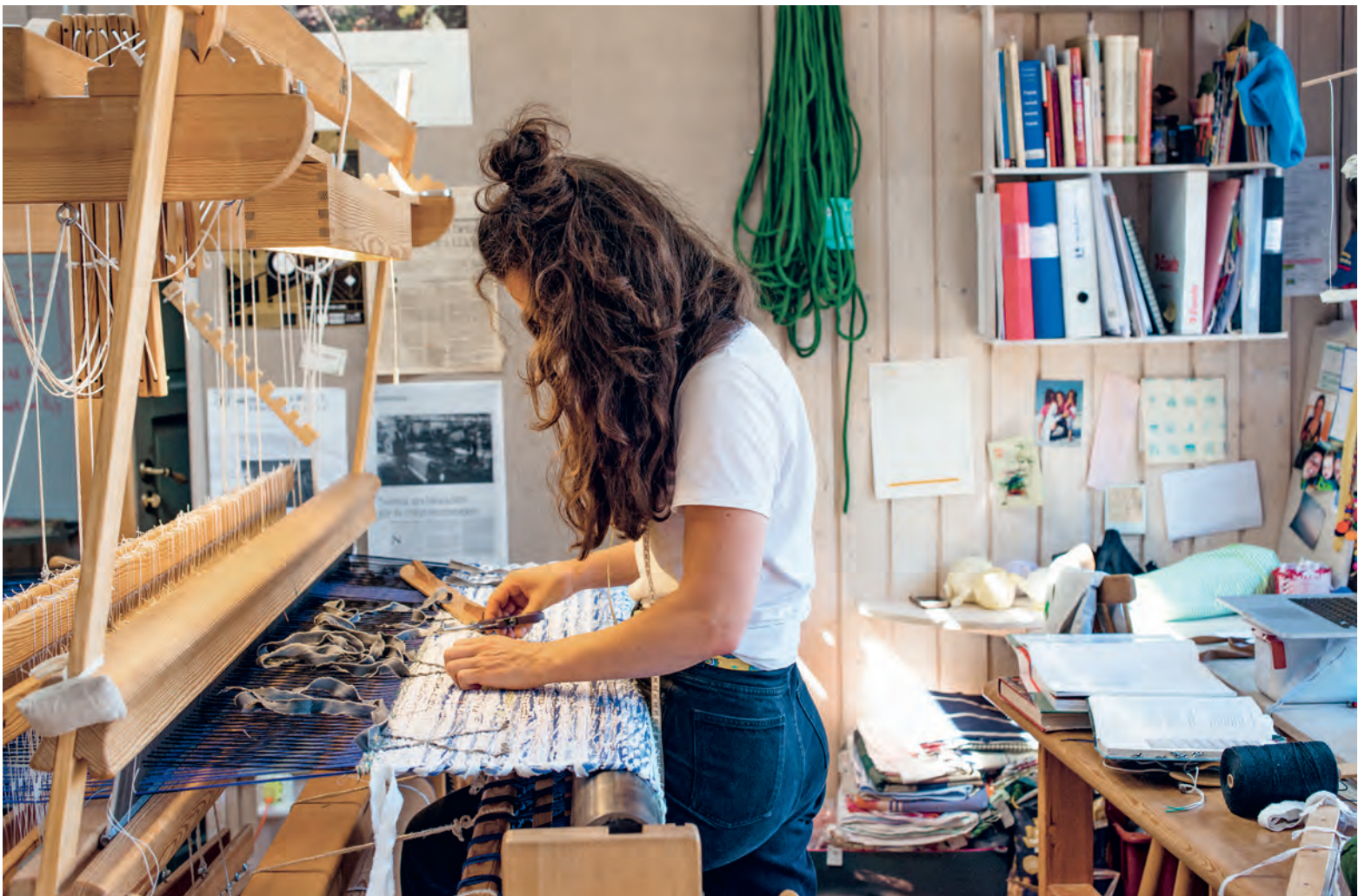
Einen Handwebrahmen einzurichten, dauert Tage. Dafür lässt er sich flexibel an das Format des Gewebes anpassen.
