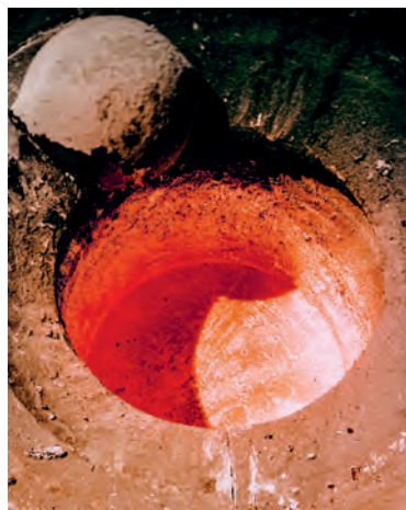
Das recycelte Aluminium schmilzt bei rund 650 Grad.
