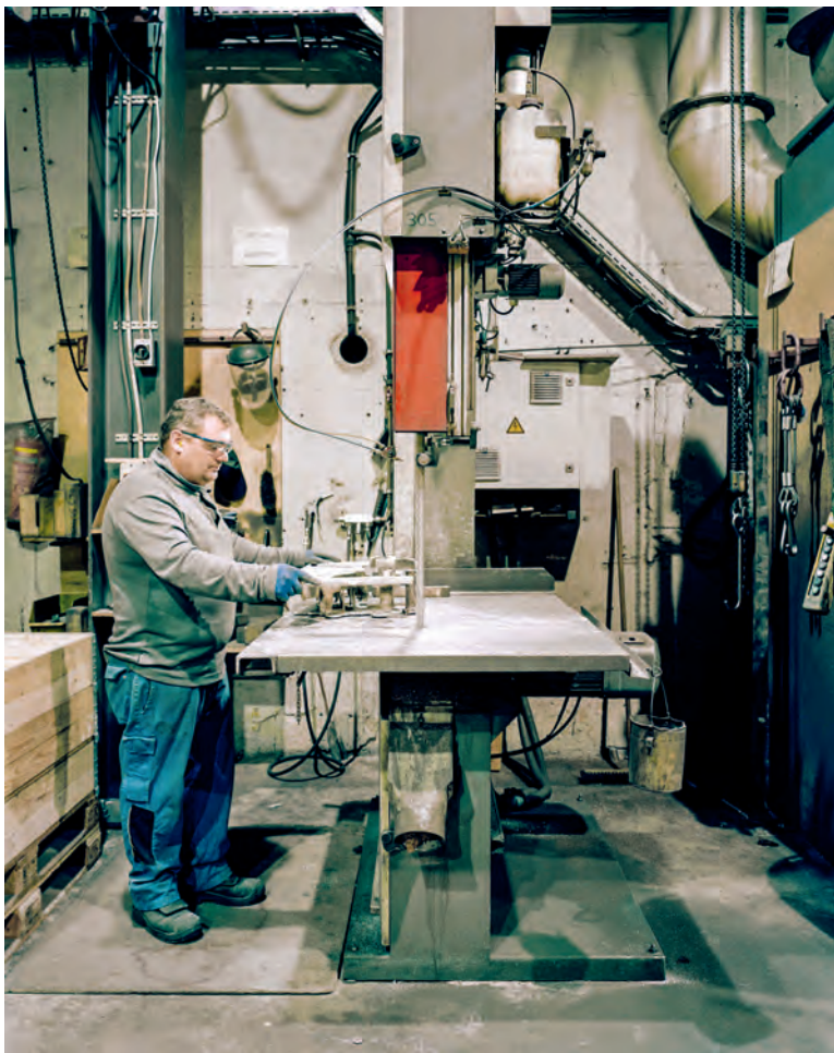
Ein Arbeiter trennt die Giessstruktur vom eigentlichen Gussteil ab, das danach abgeschliffen wird.
